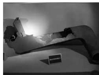
亜硫酸ガスが溶けた雨で腐食した雨樋
